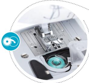
Mit dem integrierten Nadeleinfädler ist der Faden schnell eingefädelt.
