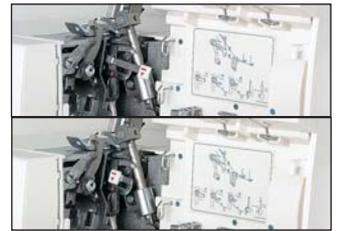
Einfädelhilfe für den unteren Greifer
